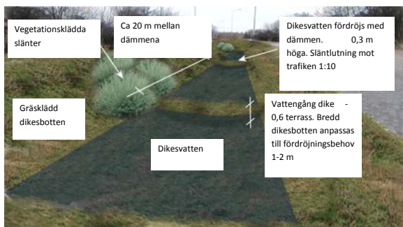
Principiell förslagsskiss på hur fördröjning i dike kan utformas med fördröjningsvallar.
