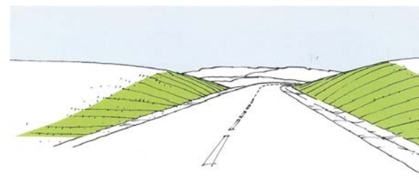
Propellerbladslänt ger en mjuk övergång till omkringliggande landskap. Källa: Vägen, en bok om vägarkitektur.
